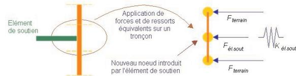
Fig. 4.7. Considération d'un élément d'appui
