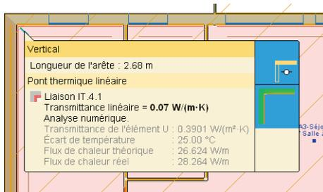
Figure 123 - Analyse aux éléments finis
