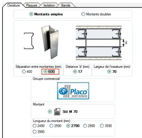
Figure 60 - Sélection de l'ossature de la cloison de séparation
