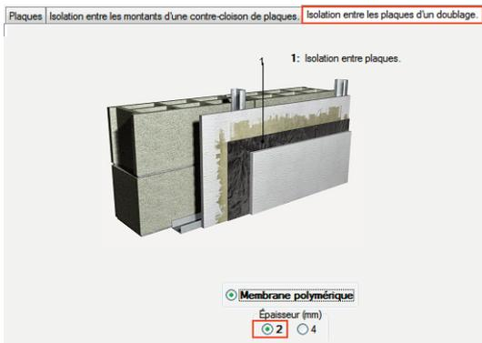
Figure 34 - Sélection de l'isolation entre les plaques de la paroi mitoyenne
