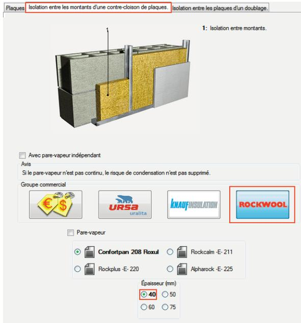
Figure 33 - Sélection de l'isolant de la paroi mitoyenne
