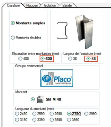
Figure 65 - Sélection de l'ossature de la cloison de distribution
