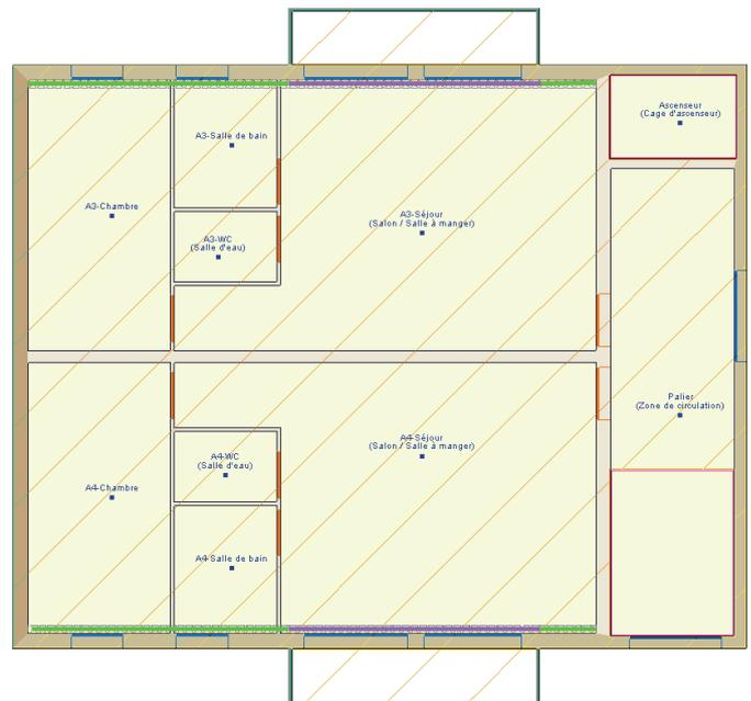
Figure 126 - Mise en place des rupteurs
