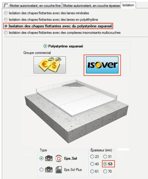
Figure 87 - Sélection de l'isolation sous chape
