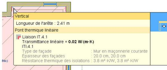
Figure 35: Visualisation des ponts thermiques
