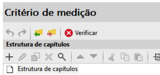
Acima da barra de ferramentas de edição da estrutura, apresentam-se algumas ferramentas para desfazer (CTRL+Z) ou refazer (CTRL+Y), para importar ou exportar a estrutura de capítulos (no formato FIEBDC-3) e para verificar a integridade da estrutura criada.
