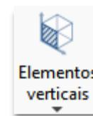
A ferramenta parede permite a criação de elementos superficiais verticais ou inclinados; a ferramenta permite distinguir diferentes categorias: *parede exterior*, *interior*, *meeira* ou *muro de cave*. O processo de criação é análogo ao descrito para lajes e pilares.
