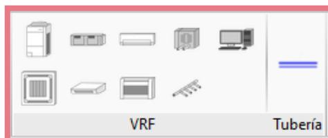
**VRF.** Para diseñar un sistema VRF, el usuario introduce las unidades interiores y una unidad exterior y las conecta mediante tuberías. El programa comprueba las longitudes de las tuberías, que el ratio de conexión esté dentro del rango permitido, y que el diseño del esquema esté dentro de las configuraciones permitidas.
