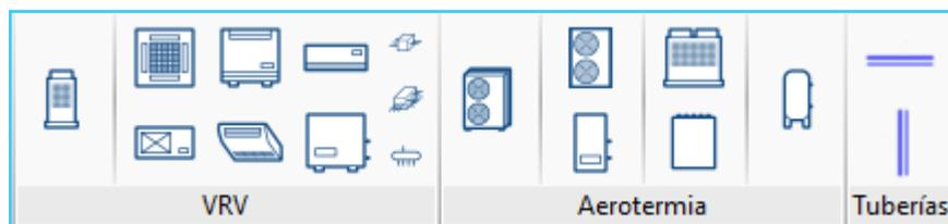
**VRV.** Para diseñar un sistema VRV, el usuario introduce las unidades interiores y una unidad exterior y las conecta mediante tuberías. El programa comprueba las longitudes de las tuberías, que el ratio de conexión esté dentro del rango permitido, y que el diseño del esquema esté dentro de las configuraciones permitidas.
