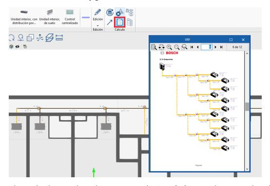
Genere planos de planta y plano de esquema. Pulse **Imprimir** y guarde en su ordenador.
