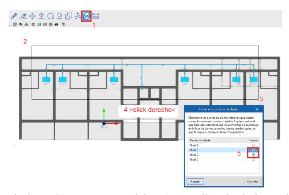
Vaya a la planta cubierta, ponga una unidad exterior. Para dibujar la tubería y que baje coincidente por el patinillo, es útil poner una profundidad de vista de 4 metros para vislumbrar la instalación de la planta inferior.
