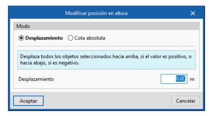
Al aceptar verá que los objetos han sido desplazados, y que el programa ha generado automáticamente los tramos de tubería vertical necesarios para que el sistema siga conectado.
