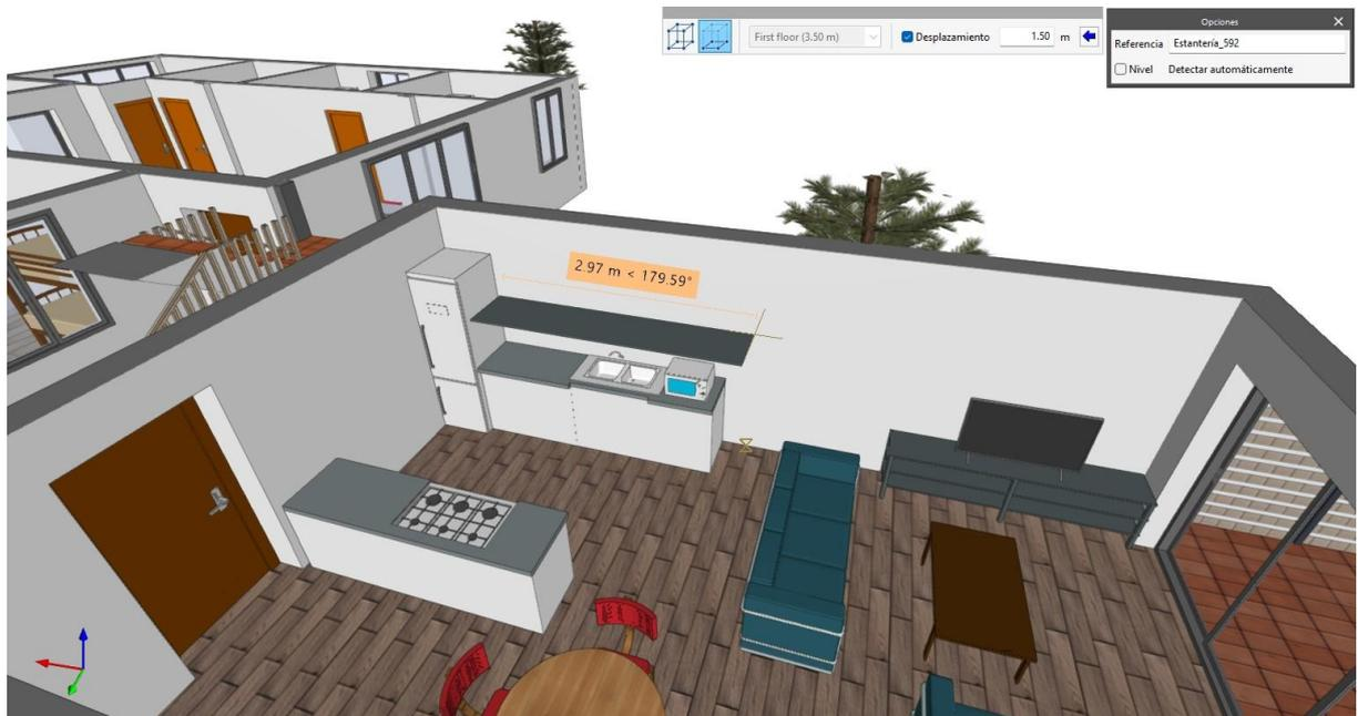
Fig. 17. Introducción de un componente con desplazamiento sobre el plano de trabajo (CYPE Architecture)
