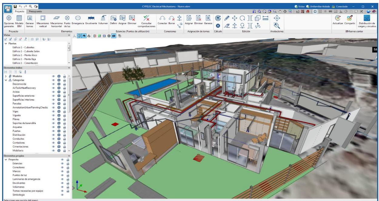
Fig. 13. Gestión de los elementos leídos en CYPELEC Electrical Mechanisms.
