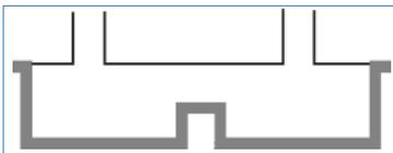
Fig. 2.5. Viga de cimentación
