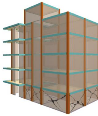
CYPECAD genera automáticamente varios estados de comportamiento del edificio en función de un criterio de rotura que relaciona el daño sufrido por un elemento con el desplazamiento relativo de sus extremos. En cada estado, cada elemento confinado lateralmente aporta un porcentaje de su rigidez en función del nivel de daño alcanzado por el mismo.
