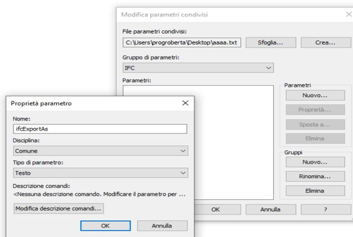
Dopodiché dobbiamo inserire il parametro condiviso creato con parametro nel progetto d'esempio. Quindi selezioniamo **Gestisci > Parametro del progetto > aggiungi e selezioniamo il file con estensione .txt** che abbiamo creato anteriormente ed il parametro "ifcExportAs". Lo applicheremo alla categoria PAVIMENTI, assicurandoci che venga caricato ed accettiamo.
