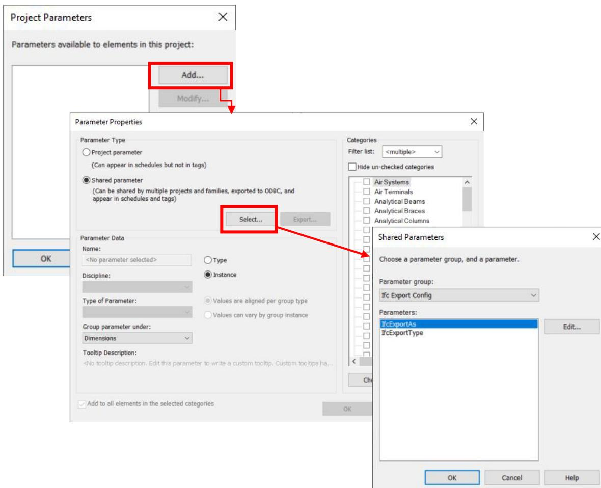
Questi parametri saranno parametri esemplari che saranno raggruppati in Parametri IFC e saranno applicati alle categorie di famiglie che si desidera esportare specificando più di quanto specificato nella configurazione di esportazione IFC, come ad esempio gli apparecchi sanitari:
