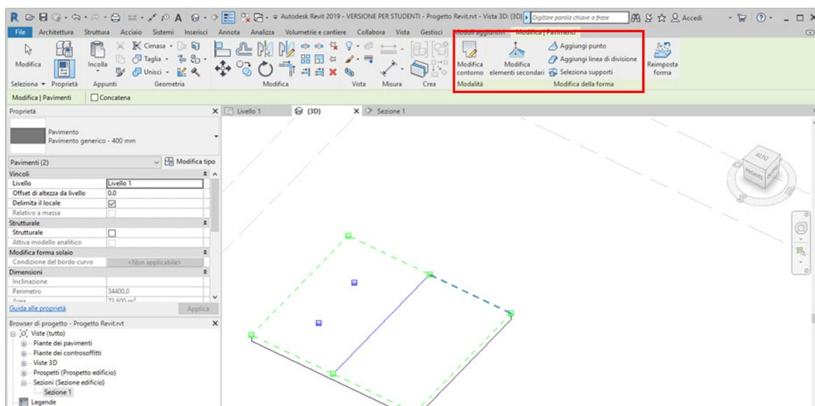
5. Per esportare a programmi di modellazione come CYPECAD MEP o IFC Builder, le coperture inclinate non possono oltrepassare i livelli (esempio: impostare il livello di gronda alla base del livello 3 e la linea di colmo all'estremo del livello 3); negli altri casi, la relazione tra la copertura ed i muri limitrofi sarà imprevedibile.
