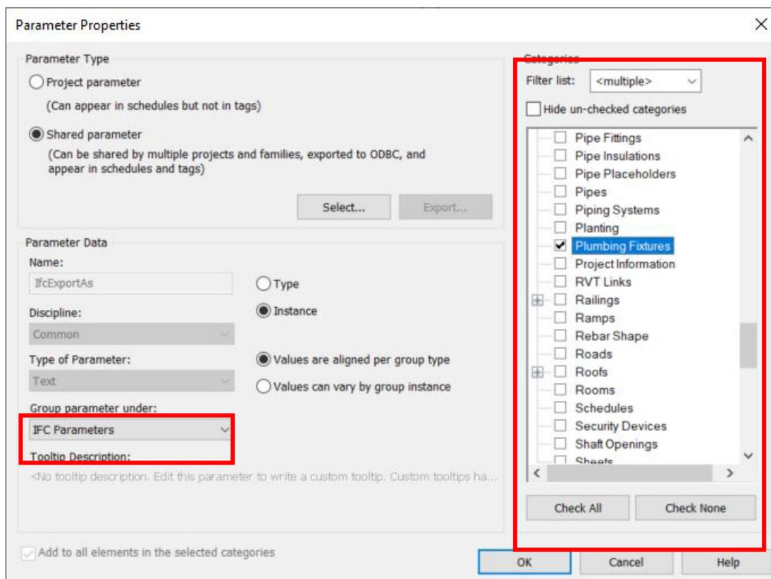
Una volta creati i parametri, sia l'entità IFC che il tipo di IFC devono essere assegnati a ciascuno degli elementi idraulici. Le entità e i tipi per i diversi dispositivi idraulici sono quelli definiti nella norma IFC:
