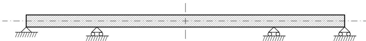
Partiremos de la pieza introducida en CYPE 3D, obtendremos la frecuencia fundamental (del primer modo), de oscilación del elemento, modelizaremos la oscilación del punto más crítico mediante un resorte equivalente, obtendremos la fuerza equivalente que representa al sismo vertical, mediante la entrada en el espectro definido en la norma.
