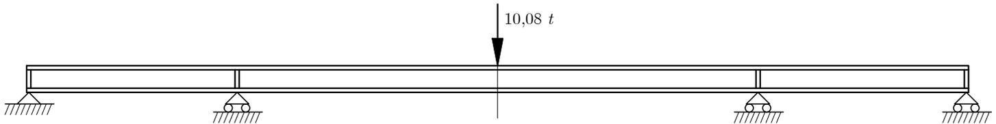
Creamos una hipótesis simple de sismo, para aplicar de manera estática la carga. En este caso, la carga no provoca un incremento de sección, de hecho el coeficiente de aprovechamiento continúa siendo el mismo, en el listado de comprobaciones E.L.U. se puede verificar que la combinación que determina el dimensionado es:
