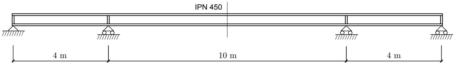
Supongamos una viga metálica continua como la de la figura, y que la viga se ha dimensionado para las siguientes hipótesis de carga, una carga permanente de 500 Kp/m<sup>2</sup>, y una sobrecarga de 400 Kp/m<sup>2</sup>, actuando sobre una banda de 5 metros de afección a la viga. Además, una segunda sobrecarga puntual de 2,5 t. Las sobrecargas las consideramos en zonas de acceso público (categoría C, según CTE - DB - SE)
