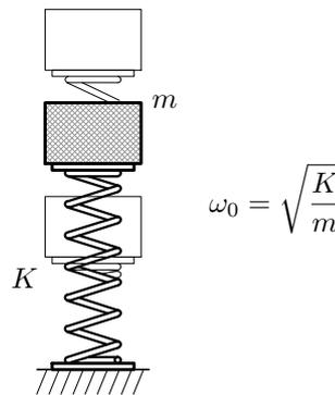
El problema es la determinación de la masa, ya que una parte de la misma, no actúa en la vibración, quedándose en los apoyos, con lo que no sabemos que masa considerar, y utilizaremos otro método para la determinación de la frecuencia.
