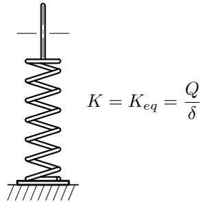
En un resorte cualquiera, con una masa  $m$ , depositada sobre él, la frecuencia natural de oscilación,  $\omega_0$ , viene definida por la siguiente fórmula:
