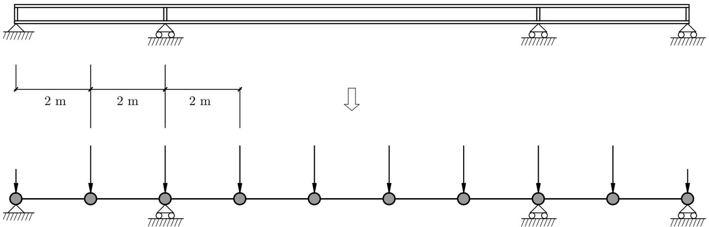
Para cada valor de  $P_i$ , hay un desplazamiento  $y_i$ , en la combinación que buscamos. Como la combinación definida no existe en el calculo, aplicamos el principio de superposición.
