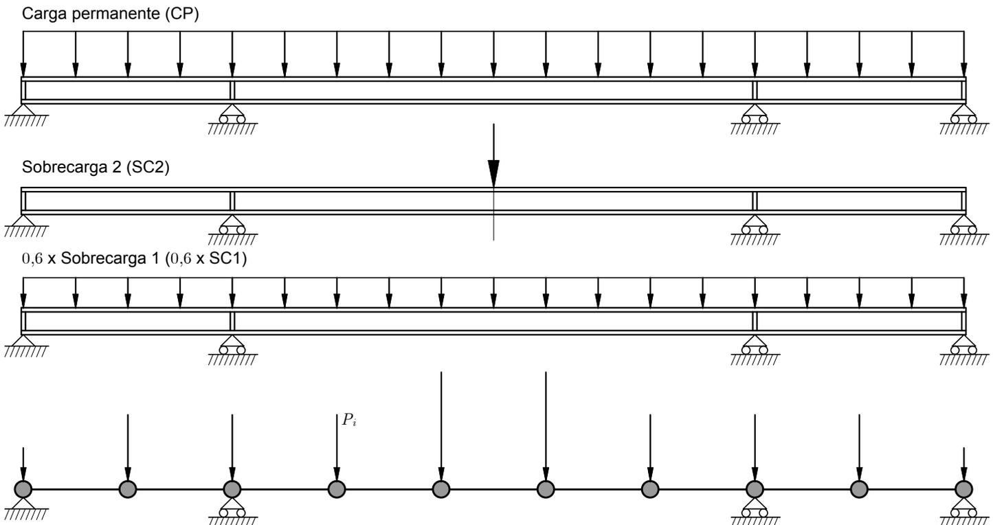
A partir de cada hipótesis es sencillo calcular el valor de cada  $P_i$ , (que no es necesario disponer en el programa), para cada hipótesis y luego componerlos mediante el principio de superposición.
