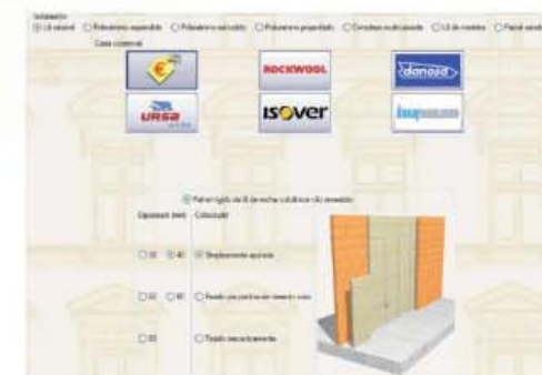
Figura 1 - Soluções construtivas disponibilizadas pela base de dados para o isolamento de paredes divisorias de alvenaria.
