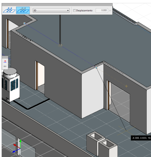
Fig. 13. Comparaison des modes d'introduction 2D et 3D (Open BIM Lightning)
