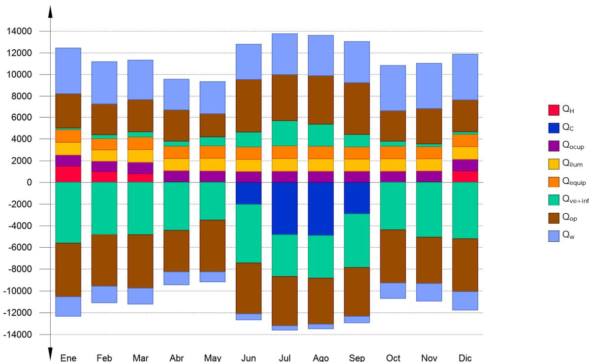
En la siguiente tabla se muestran los valores numéricos correspondientes a la gráfica anterior, del balance energético del edificio completo, como suma de las energías involucradas en el balance energético de cada una de las zonas térmicas que conforman el modelo de cálculo del edificio.
